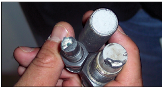
Estes sensores foram destruídos por impacto ou abrasão. Os sensores de aço inoxidável são essenciais para a detecção em ambientes adversos. Podem ser brutalmente agredidos, e mesmo assim, continuar funcionando.
